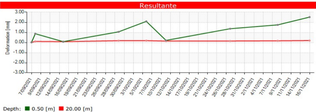
Figura 2. Evolución del desplazamiento del inclinómetro a lo largo de las campañas realizadas. Inclinómetro VG INC-01.
