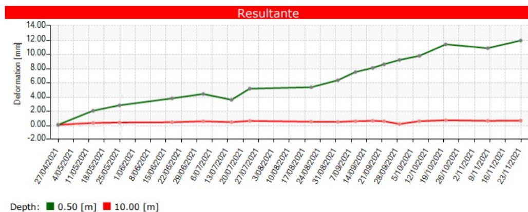
Figura 3. Evolución del desplazamiento del inclinómetro CPA INC-01 a lo largo de las campañas realizadas.
