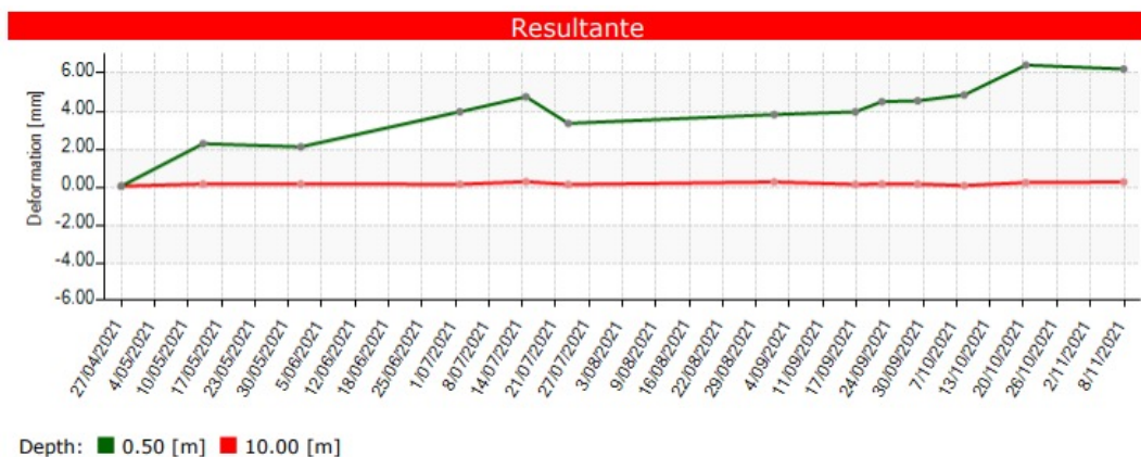
Figura 5. Evolución del desplazamiento del inclinómetro CPA INC-02 a lo largo de las campañas realizadas.
