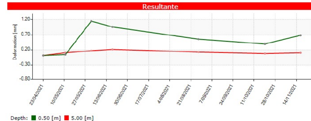
Figura 2. Evolución del desplazamiento del inclinómetro a lo largo de las campañas realizadas.
