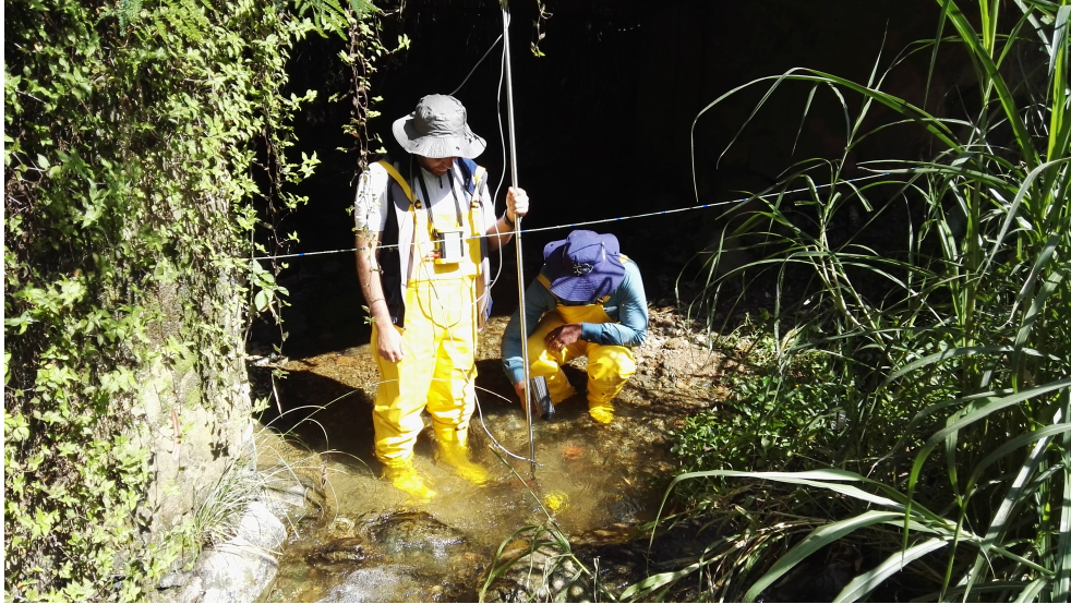
Figura 3.7: Toma de datos con correntómetro y sensor de velocidad superficial.
