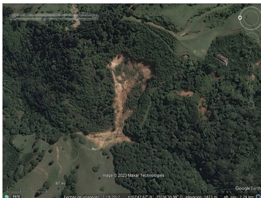
Figura 4: Imagen registrada en febrero de 2012. Nótese, además del movimiento en masa monitoreado, otros movimientos en masa de menor escala en la ladera. Imagen tomada de Google Earth.
