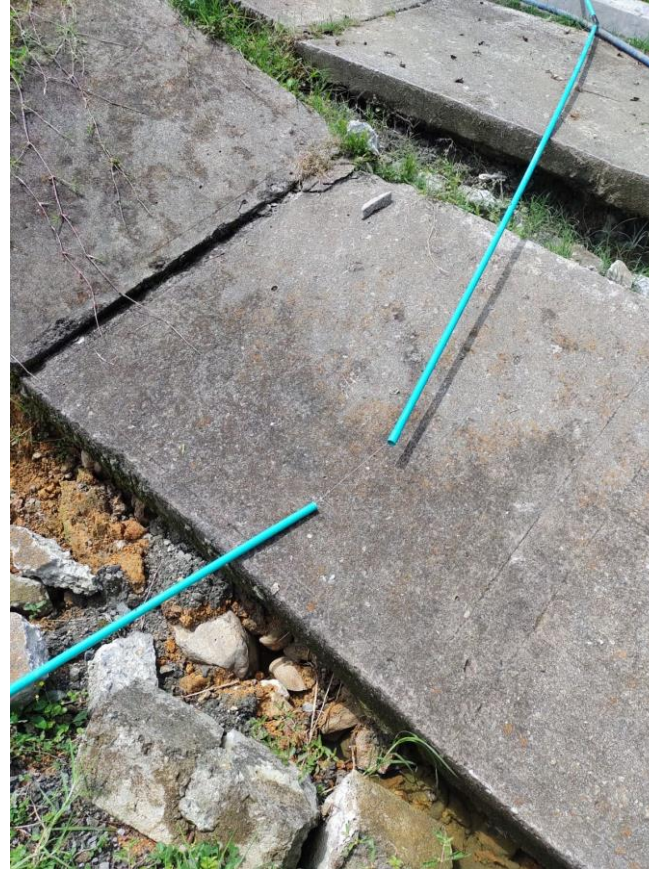
Figura 9. Afectación en la estación instalada en el sitio, donde se observa el estado de la estación principal y la rotura de los cables tanto del equipo TDR como del extensómetro instalado.
