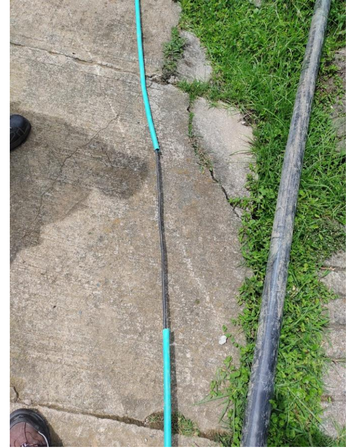
Figura 9. Afectación en la estación instalada en el sitio, donde se observa el estado de la estación principal y la rotura de los cables tanto del equipo TDR como del extensómetro instalado.
