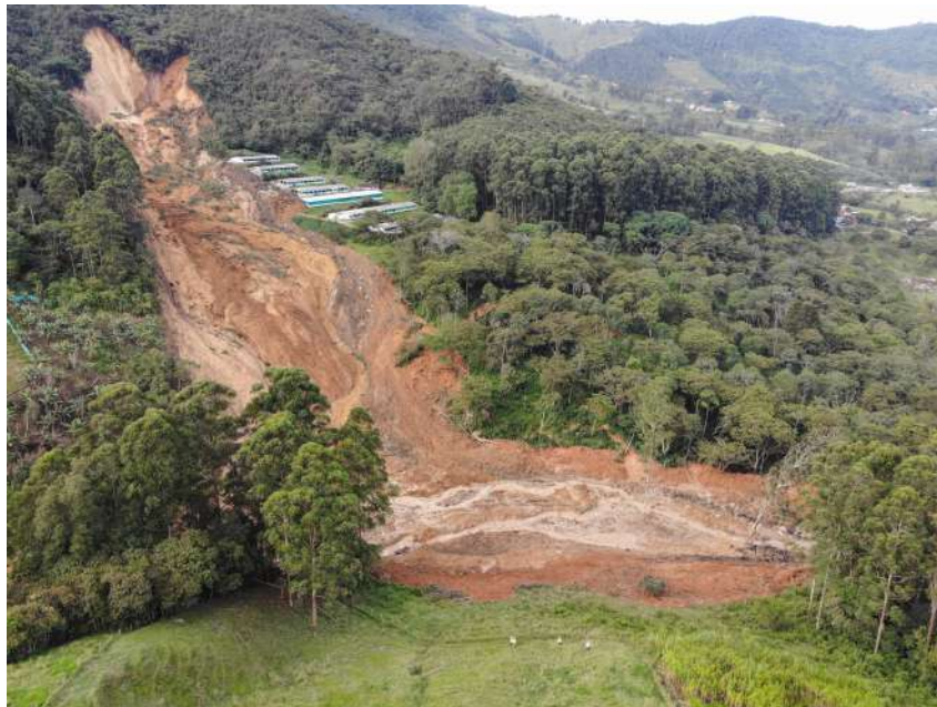
Figura 2: Fotografía del movimiento en masa en el sector Las Playas. En el lado derecho se observan grietas en el terreno, asociadas a otro proceso morfodinámico activo en la ladera.
