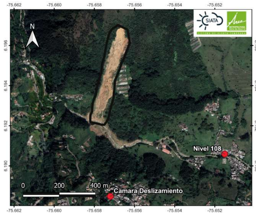
Figura 1: Ubicación del sitio Las Playas y sensores instalados en el sitio. La granja avícola se encontraba en el flanco este del movimiento en masa.
