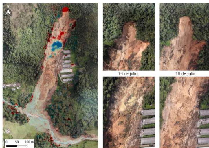
Figura 13: Análisis de deformaciones del terreno entre julio 14 y julio 18 de 2022, realizado al movimiento en masa por parte del equipo de Teledetección con Drones de SIATA. Las zonas de color rojo indican desplazamientos negativos (hundimientos) y las zonas de color azul indican desplazamientos positivos (llenos o depósitos). Se observan desprendimientos en la parte media del movimiento en masa y acumulación de este material en la parte media y baja del movimiento en masa.
