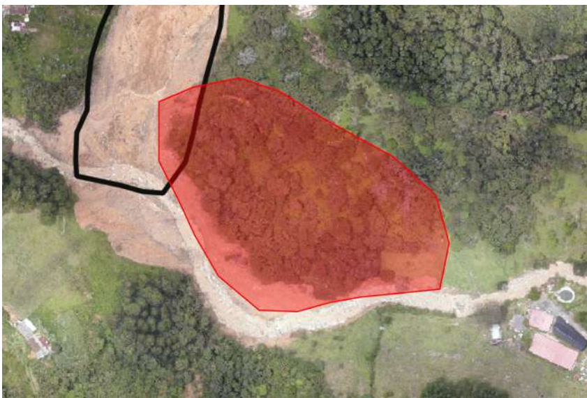
Figura 6: Zona con deformaciones del terreno en el flanco este del movimiento en masa Las Playas, identificadas en la ortofotografía del sobrevuelo con drones del 9 de septiembre de 2022 (polígono rojo).
