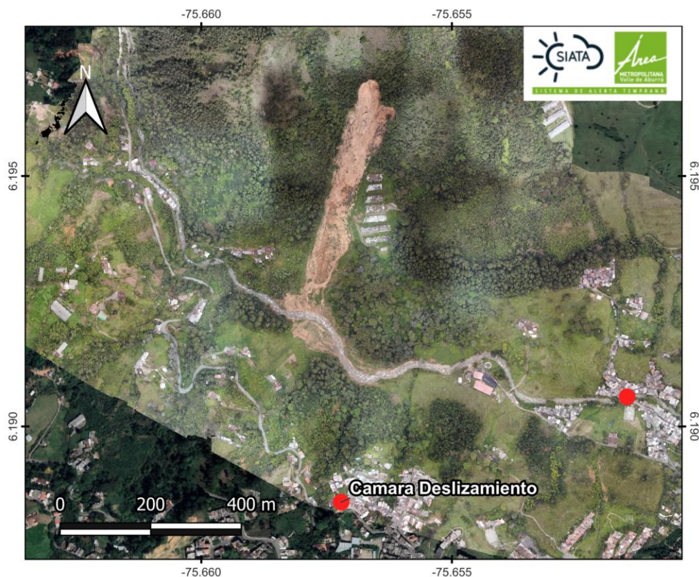
Figura 1. Ubicación del movimiento en masa Las Playas y sensores en tiempo real SIATA.
