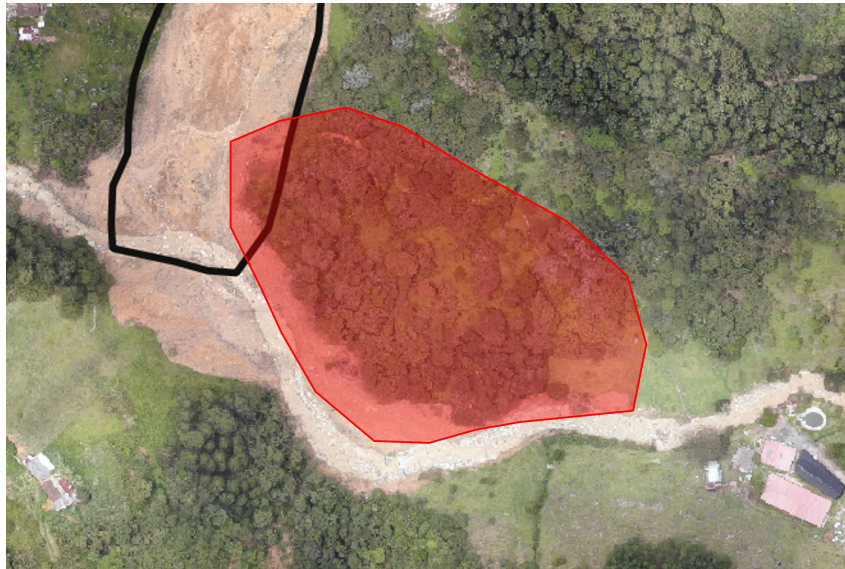
Figura 12: Zona con deformaciones del terreno en el flanco este del movimiento en masa Las Playas, identificadas en la ortofotografía del sobrevuelo con drones del 9 de septiembre de 2022 (polígono rojo).
