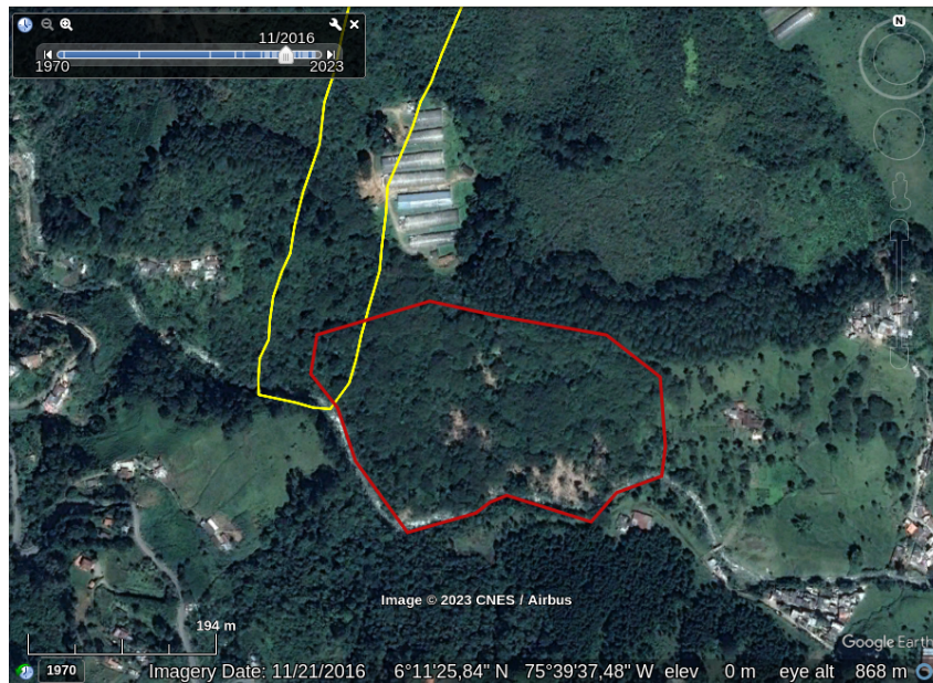
Figura 10: El polígono rojo enmarca las evidencias de deformación en la parte baja de la ladera. El polígono amarillo delimita la sección del movimiento en masa Las Playas. Imagen de noviembre de 2016 tomada de la plataforma Google Earth.
