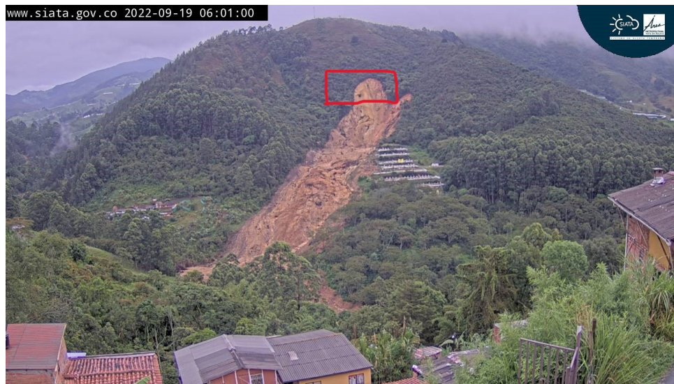
Figura 14: Fotografía de la cámara de monitoreo registrada el 19 de septiembre de 2022. Nótese el desprendimiento de una masa de suelo desde la corona del movimiento en masa.
