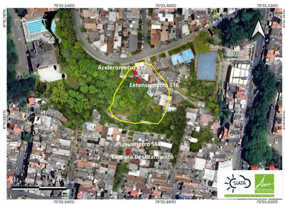
Figura 1: Localización del punto critico La Bermejala y ubicación específica de sensores para monitoreo.
