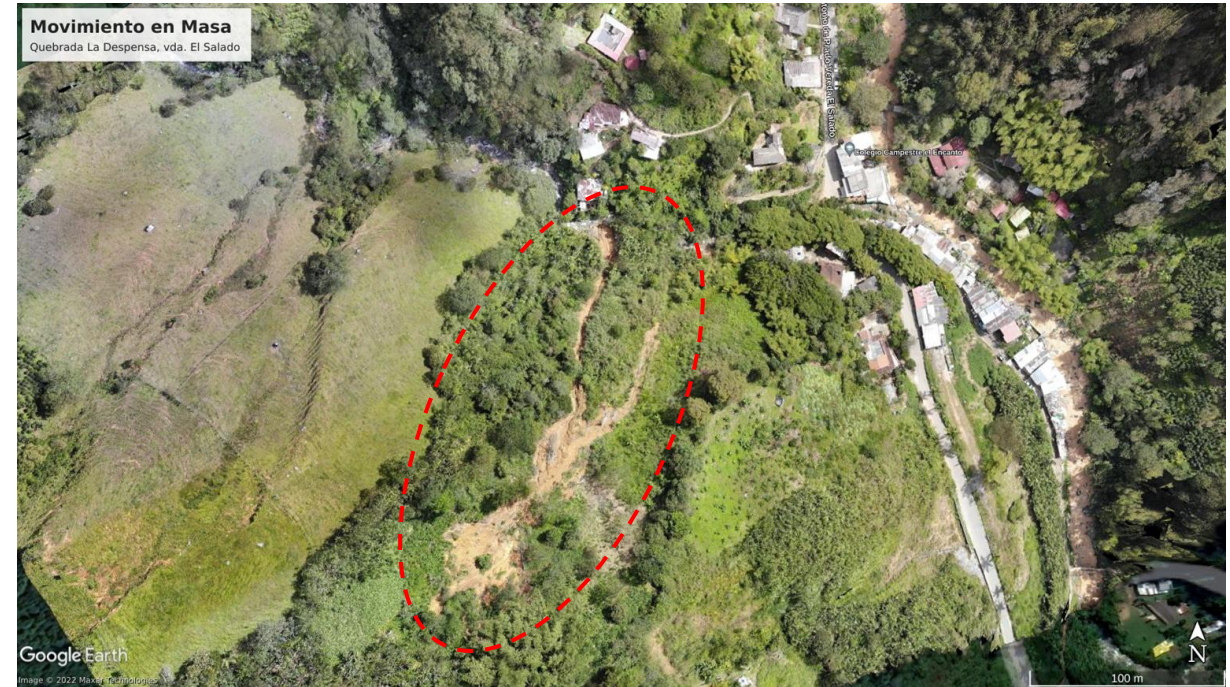
Figura 1. Sobrevuelo de la zona afectada en una ladera cercana de la desembocadura de la quebrada La Despensa a la Doña María. La zona marcada muestra el movimiento en masa tipo flujo.
