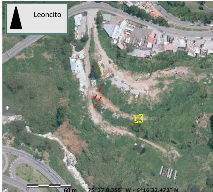
Figura 1. Ortofoto del sector Leoncito. Líneas punteadas indican ubicación de grietas en el terreno. Estrella amarilla indica ubicación del inclinómetro.
