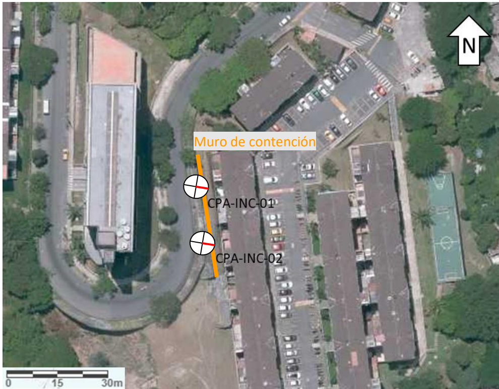
Figura 1. Ubicación de los inclinómetros convencionales monitoreados en la parte alta del barrio Calasanz parte alta.
