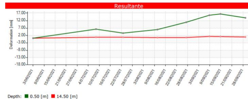
Figura 3. Evolución del desplazamiento del inclinómetro OR INC-01 .
