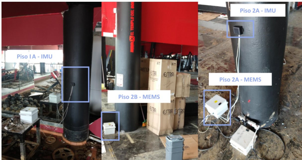
Figura 4: Izq: Acelerómetro IMU columna A primer piso. Cen: Acelerómetro MEMS columna B segundo piso. Der: Acelerómetro MEMS y IMU columna B segundo piso.
