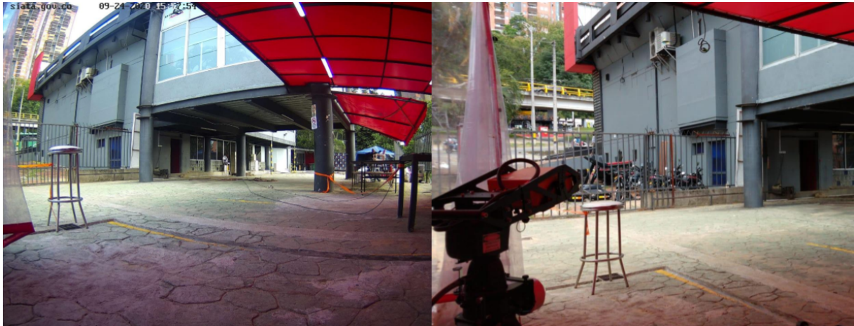
Figura 5: Izq: Cámara integrada al Radar Hydra G - Vista principal del monitoreo. Der: Radar Interferométrico Hydra G.
