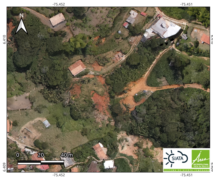
Figura 5: Deslizamiento superficial con posibles afectaciones a edificación residencial.
