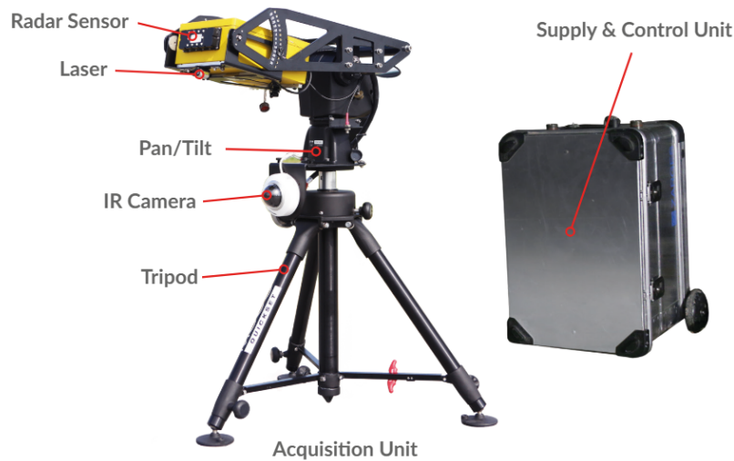
Figura 3: Esquema de los componentes principales del Radar Interferométrico HYDRA G.
