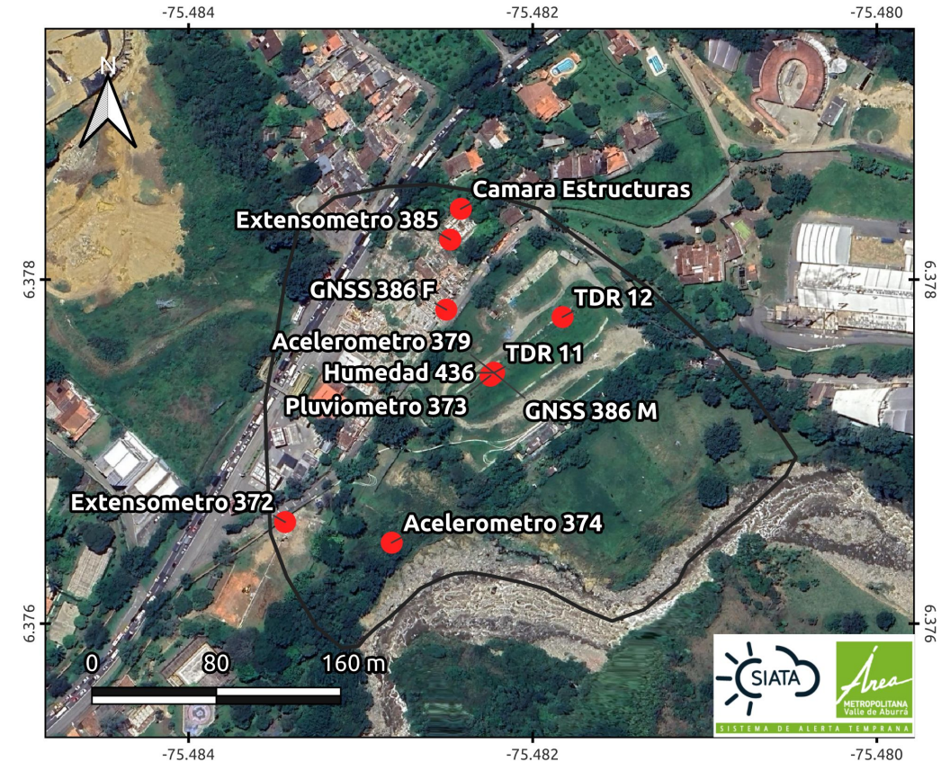
Figura 1. Configuración del esquema de monitoreo en la zona de afectación del movimiento en masa de la vereda Ancón II (Copacabana).
