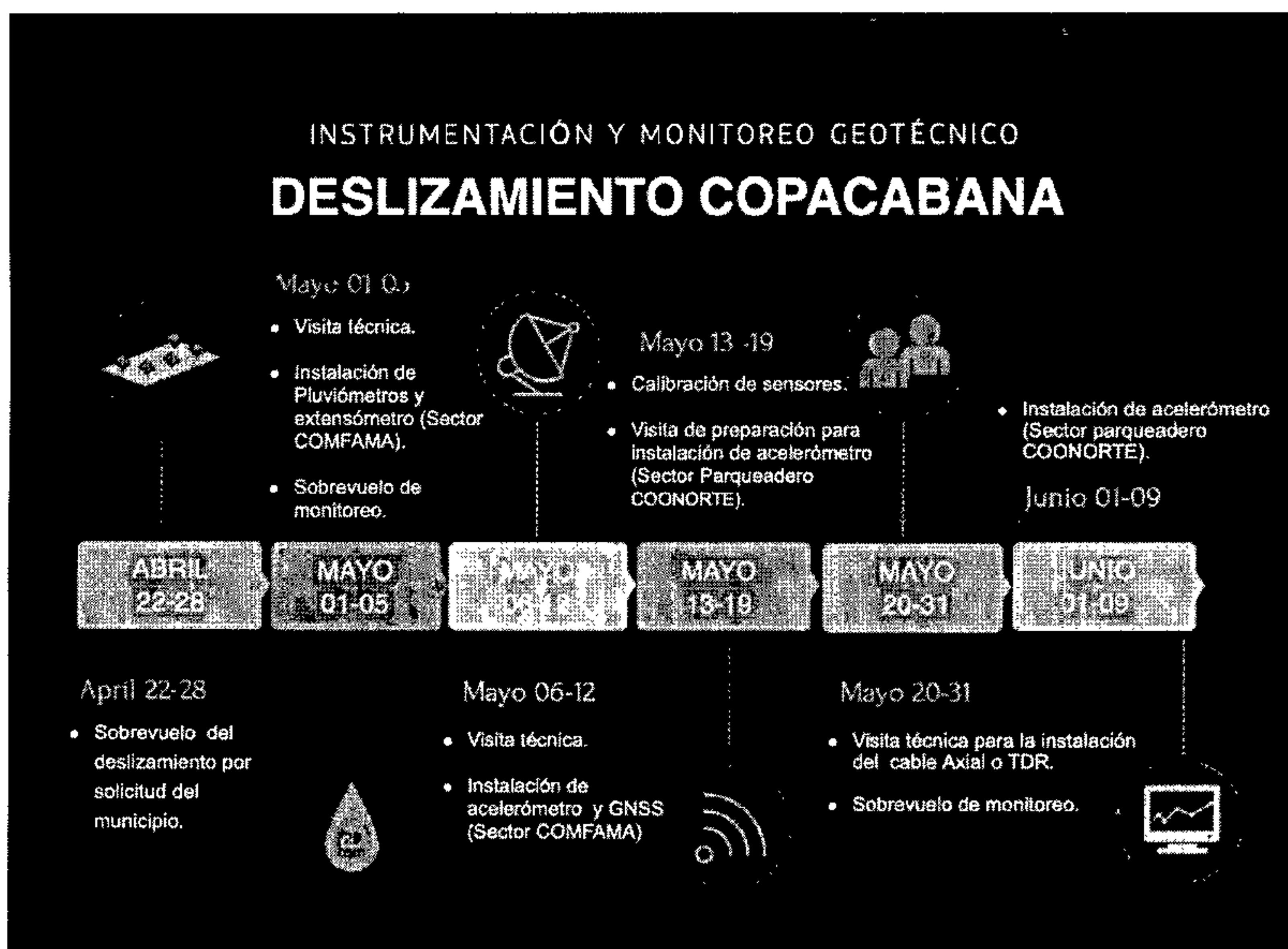
Figura 1: Línea de tiempo de visitas técnicas, el proceso de instalación y calibración de equipos y los resultados preliminares arrojados por los sensores.
