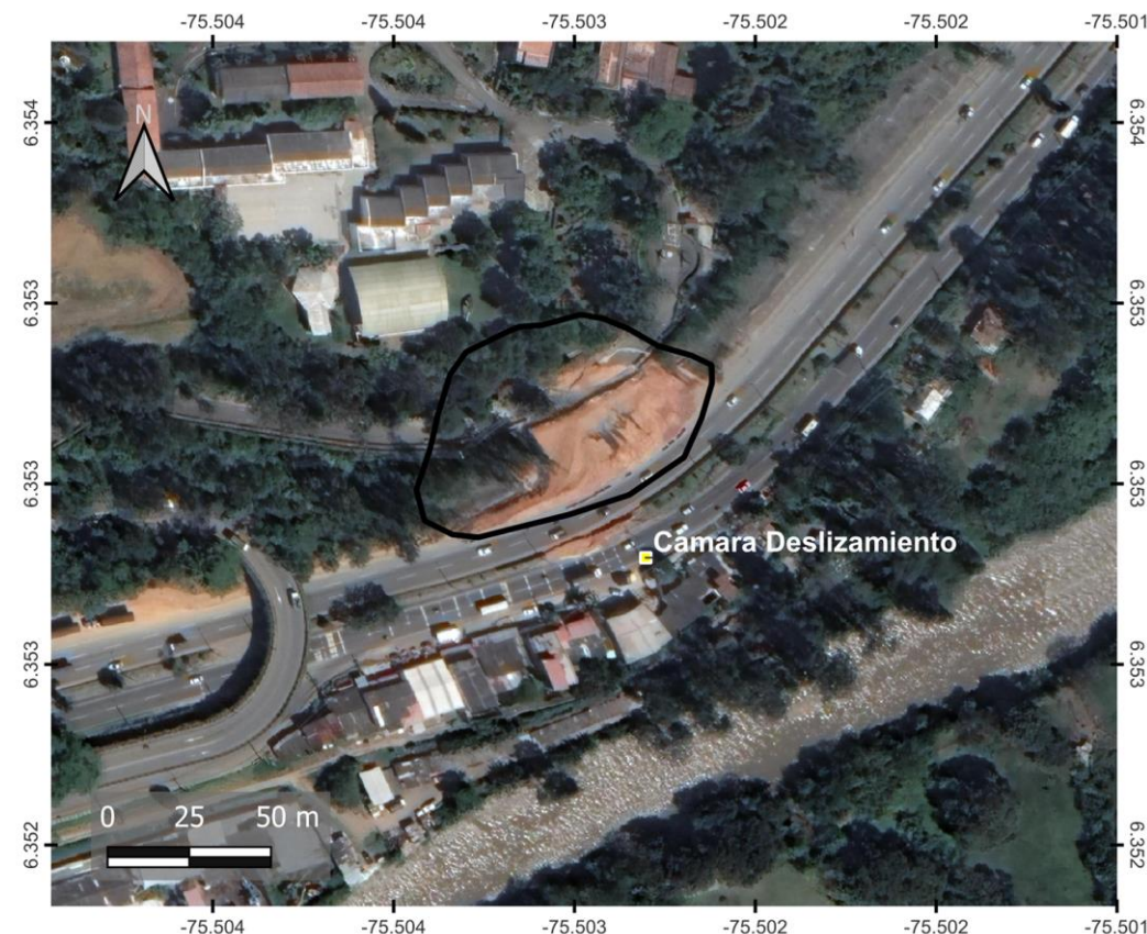
Figura 1. Localización del movimiento en masa Autopista Norte, sector El Vivero Copacabana y sensores instalados en el sitio.
