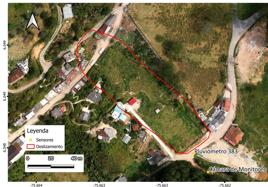
Figura 1: Localización del movimiento en masa Salinas y sensores activos. Se ingresa por la vía Caldas - Amaga, km 6.5, tomando la vía de la vereda Salinas, desde la Institución Educativa Rural Salinas por 300 m hasta localizar el movimiento en masa.
