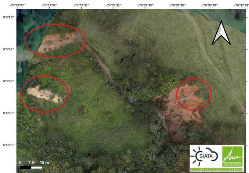
Figura 11: Detalle de la Zona Z-3 capturado durante el sobrevuelo del 21 de noviembre de 2023, mostrando el represamiento parcial de la quebrada La Corrala.
