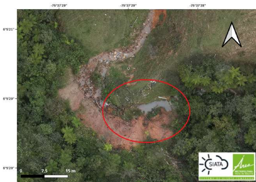
Figura 9: Acercamiento de la Zona Z-MA de la imagen del sobrevuelo realizado el 21 de noviembre de 2023, donde se observa el represamiento parcial de la quebrada La Corrala.
