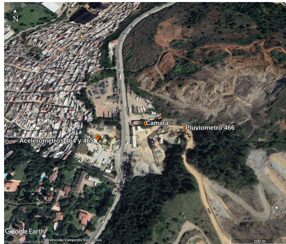
Figura 3. Ubicación de los sensores en la zona afectada.
