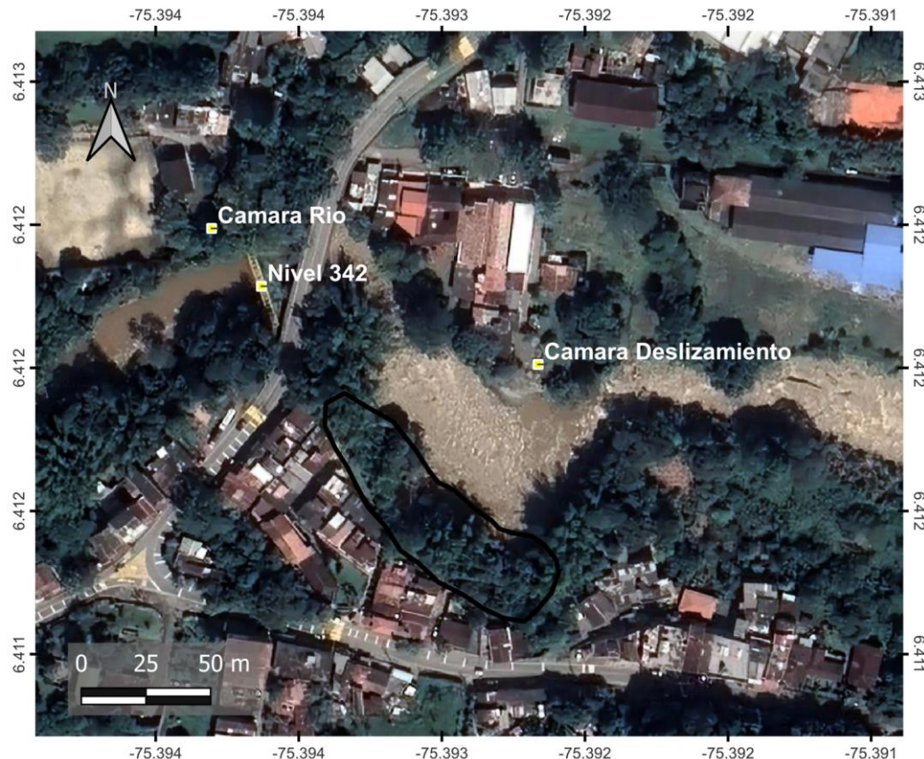
Figura 1. Ubicación de sensores en tiempo real SIATA y talud monitoreado (polígono negro) en el sector El Hatillo.
