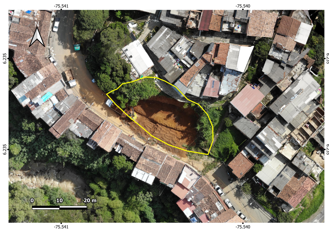
Figura 2: Ortofoto resultante del sobrevuelo realizado el 23 de junio de 2021. Se observa escarpe principal del movimiento en masa y el depósito del material desplazado sobre la vía.
