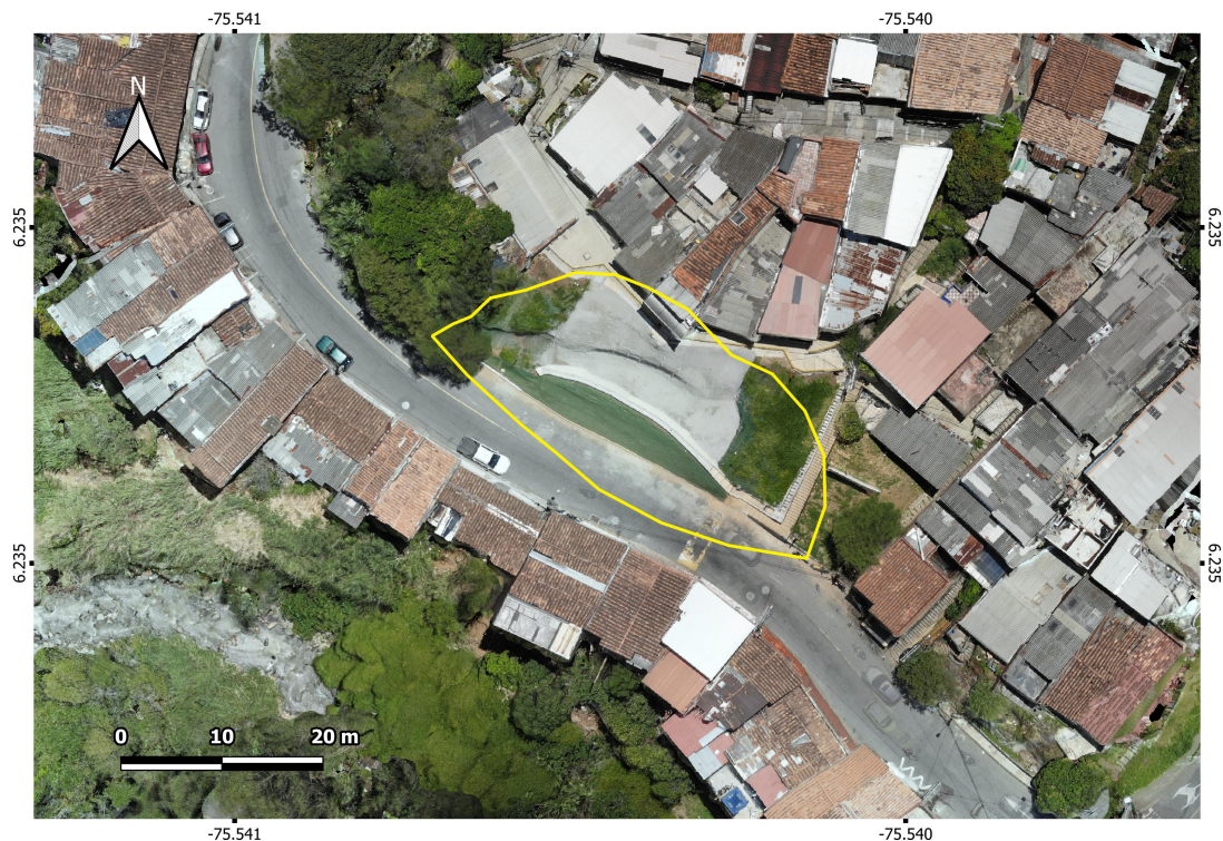
Figura 3: Ortofoto resultante del sobrevuelo realizado el 14 de agosto de 2023. Se observa movimiento en masa intervenido con finalización de obras de estabilización.
