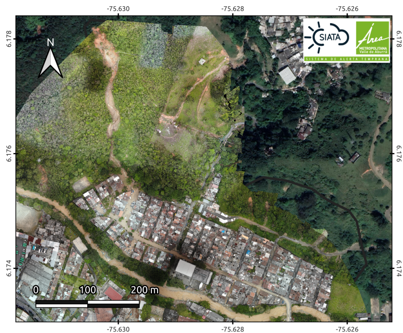
Figura 13: Ortofoto realizada el 18 de septiembre de 2022 al flujo de lodos en la ladera noroccidental del barrio Villalía.
