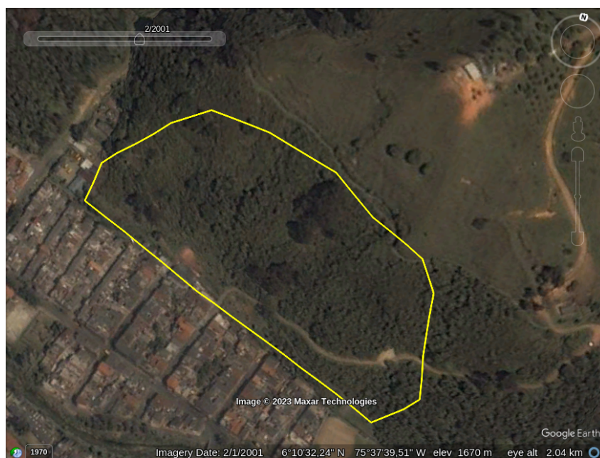
Figura 7: Imagen registrada en enero de 2001 de 2012. Nótese pequeños movmientoa en masa en la parte baja de la ladera y el camino de herradura en la parte alta del polígono de monitoreo.
