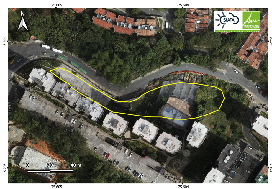
Figura 10: Ortofoto realizada el 6 de febrero de 2024 sobre el sitio de interés. Se observa la construcción de la obra de mitigación en el deslizamiento 1 y se evidencia la protección del talud a través de un techo de lona de plástico sobre el deslizamiento 2.
