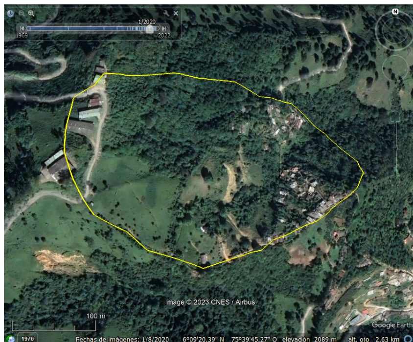
Figura 5: Imagen aérea del deslizamiento Tierra Amarilla registrada en enero de 2020. En la imagen se observa la ocupación de la zona y los procesos erosivos asociados a excavaciones en la ladera. Fuente: Google Earth.
