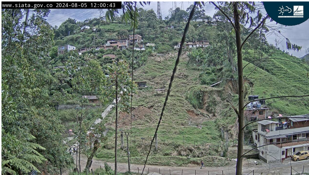
Figura 12: Fotografía de la cámara de monitoreo registrada el 8 de agosto de 2024. Se evidencia una intervención antrópica(movimiento de tierra) en la parte baja del deslizamiento en la zona de depósito.
