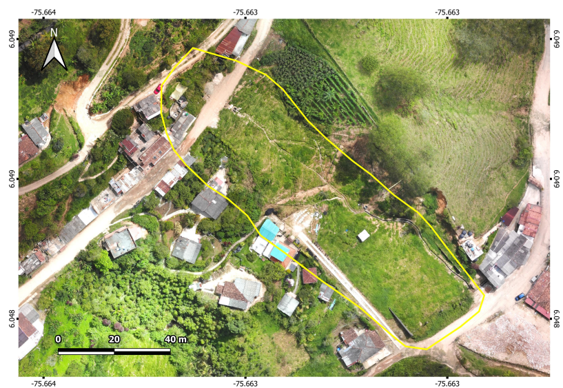
Figura 6: Ortomosaico de sobrevuelo de monitoreo realizado el 16 de junio de 2023 sobre el deslizamiento Salinas. se observa la recuperación de cobertura vegetal y la implementación de canales hidráulicos para redirigir el agua de escorrentía sobre el flanco oriental en la zona baja del deslizamiento y sobre la zona alta en el sector norte.
