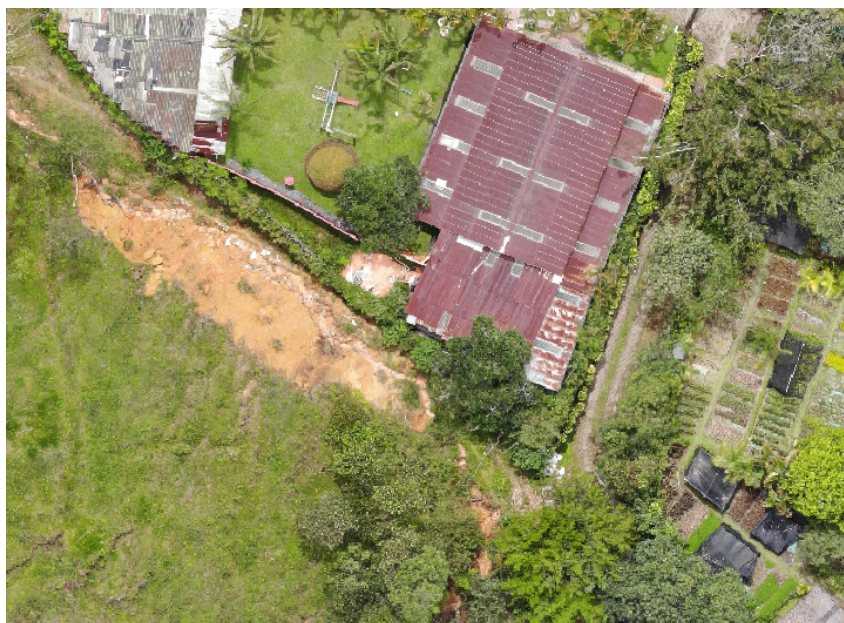
Figura 4: Acumulación de sedimentos con diámetros superiores a los 40 cm cerca de las edificaciones productivas. En esta zona se ha desarrollado un canal asociado a la escorrentía y/o afloramientos de agua en la ladera.
