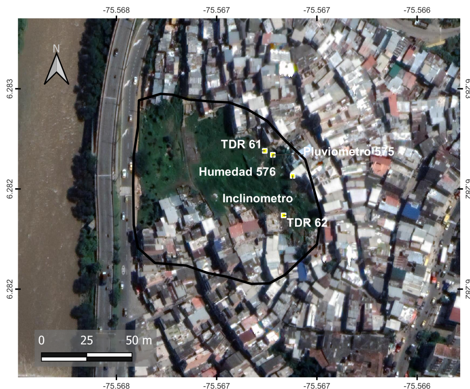
Figura 1: Ubicación del deslizamiento Oasis y sensores instalados en el sitio
