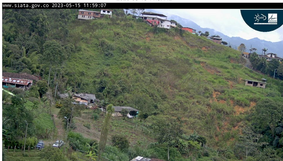
Figura 7: Fotografía registrada el 15 de mayo de 2023. Se observa la recuperación de la cobertura vegetal en toda la superficie del movimiento en masa, sin desprendimientos de material significativos. Las edificaciones sobre el escarpe principal y la recientemente construida en el flanco oriental no presentan variaciones.
