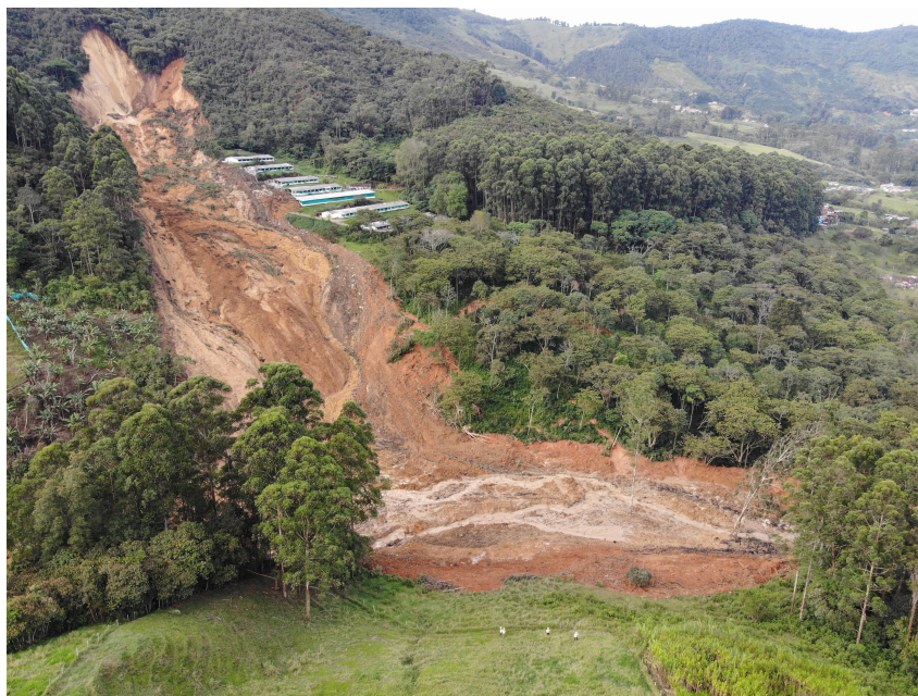
Figura 2: Fotografía del movimiento en masa Las playas. En el flanco derecha de la fotografía se observan grietas en el terreno asociadas a otro proceso morfodinámico activo en la ladera.
