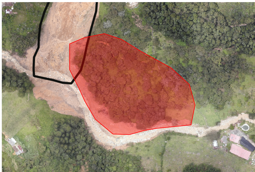
Figura 8: Zona inestable en el flanco este del movimiento en masa Las Playas. Ortofotografía del sobrevuelo con drones del 9 de septiembre de 2022.
