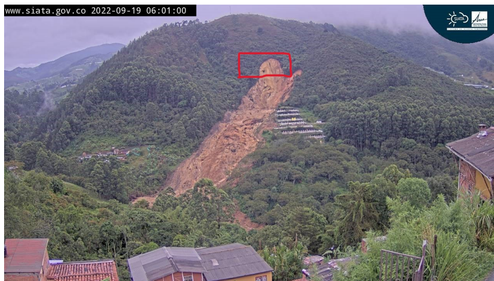
Figura 17: Fotografía de la cámara de monitoreo registrada el 19 de septiembre de 2022. Nótese el desprendimiento de una masa de suelo desde la corona del movimiento en masa.
