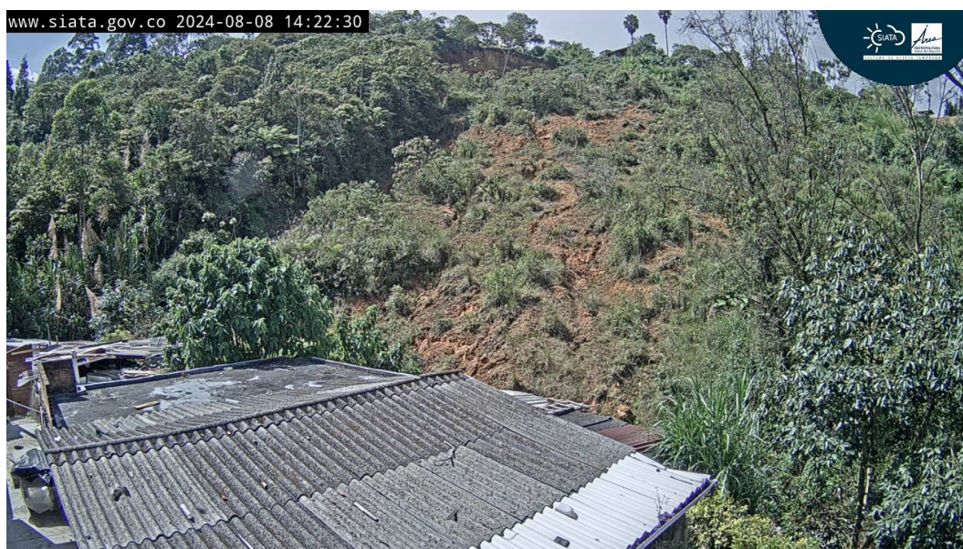
Figura 11: Fotografías de la cámara de monitoreo del deslizamiento. Fotografía registrada el 08 de agosto de 2024. Se observa continuidad en los procesos de erosión laminar en el cuerpo del depósito con recuperación de la cobertura vegetal.
