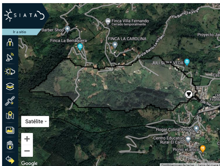
Figura 3: Área de drenaje de la microcuenca de La Raya al sensor de nivel que conforma el SATC. Nótese la ubicación del asentamiento La Raya ubicado cerca del sensor de nivel (círculo blanco). Figura tomada del geoportail SIATA https://siata.gov.co/siata_nuevo/ .
