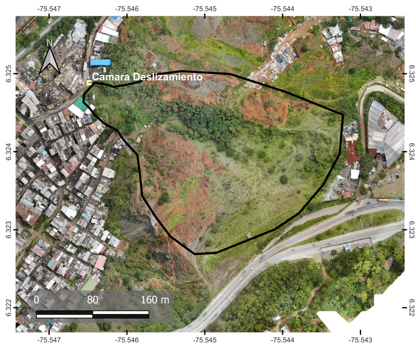
Figura 4: Ortofoto del sitio monitoreado realizado mediante sobrevuelo de drones el 29 de junio de 2022. Nótese la degradación del suelo, los procesos erosivos activos y el deslizamiento al sur del polígono.
