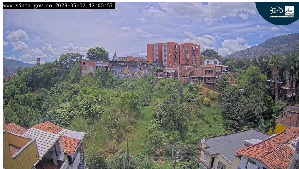
Figura 4: Fotografía registrada por la cámara de monitoreo el 2 de mayo de 2023. Se observa desgaste de la lona que recubre el escarpe del movimiento en masa y se intensifica la recuperación de la cobertura vegetal.
