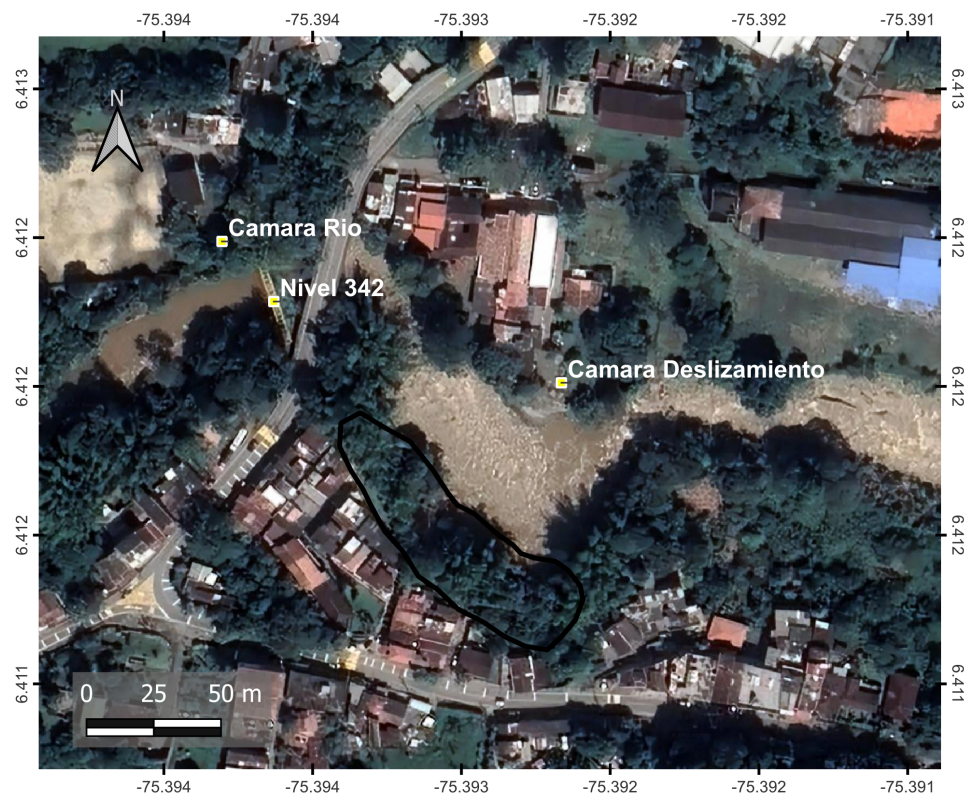
Figura 1: Ubicación del deslizamiento Pajarito y sensores instalados
