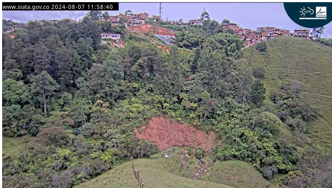
Figura 13: Fotografía de la cámara de monitoreo del deslizamiento. Fotografía registrada el 7 de agosto de 2024. Se observan intervenciones antrópicas en la parte alta de la ladera. Continúan los procesos erosivos en la parte baja del movimiento en masa.
