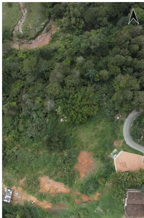
Figura 11: Fotografía del sobrevuelo realizado el 5 de junio del 2024 sobre el deslizamiento Andalucía. Se observan desechos antrópicos en la barra puntual del meandro generado por la quebrada, en la parte baja del deslizamiento. Por otro lado, en la parte alta del deslizamiento, se evidencia erosión laminar en forma de surcos con suelo parcial descubierto, en la zona del escarpe.
