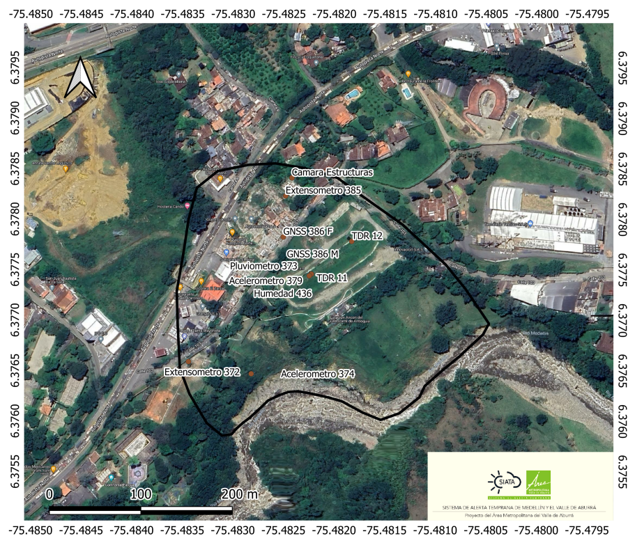
Figura 1: Ubicación del deslizamiento Ancón Norte y localización de sensores instalados
