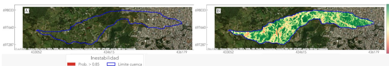
Figura 10. Zonas fuentes modeladas con: a) SHALSTAB y b) TRIGRS para la cuenca Montañita
