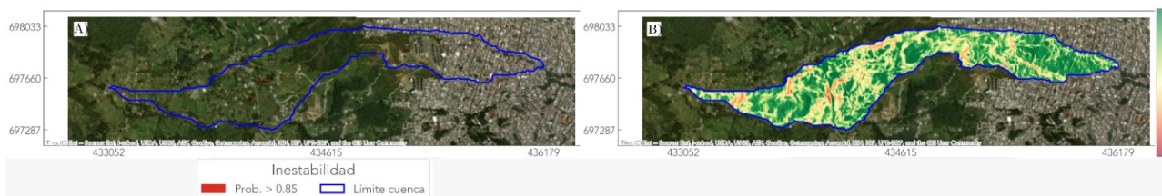
Figura 10. Zonas fuentes modeladas con: a) SHALSTAB y b) TRIGRS para la cuenca Montaña
