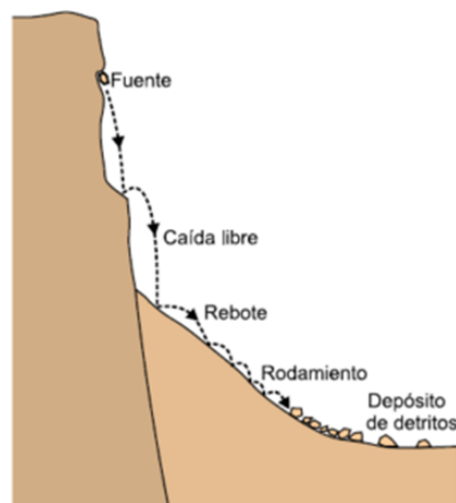
Figura 2. Esquema de caída de rocas.
