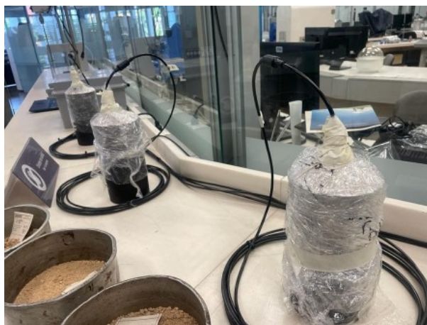
Figura 5: Montaje de sensores de humedad en el laboratorio de suelos de la Universidad EAFIT.
